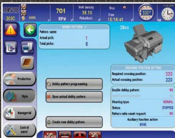
**Settaggio del Passo di Incrocio da Console**
