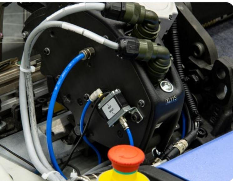
Gestibile dalla piattaforma elettronica e programmabile direttamente dal microprocessore, non richiede manutenzione. La possibilità di mettere a punto il movimento di ogni singola freccia consente un movimento delicato e permette di eliminare l'interferenza con le trame adiacenti.
