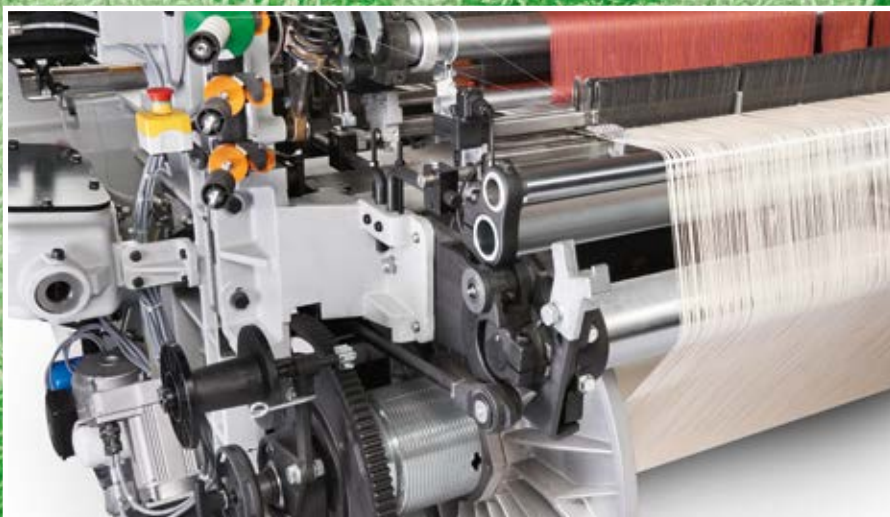
Il migliore sistema di formazione della spugna della categoria: nuovo portafili di teso
